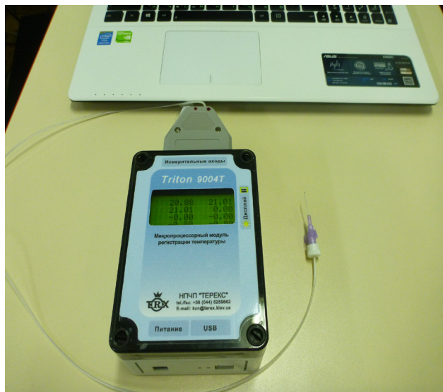
Рис.1а. Внешний вид термоэлектрического устройства для регистрации внутриглазной температуры
