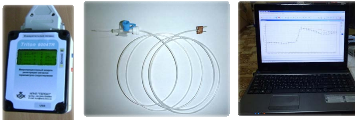
Рис. 1. Внешний вид термоэлектрического устройства для измерения внутриглазной температуры.
