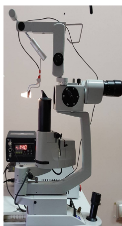
Рис. 1. Термоэлектрический прибор для определения теплового потока с поверхности глаз: 1 – термоэлектрический сенсор теплового потока, 2 – термоэлектрический датчик термопары температуры, 3 – электронный блок управления.
