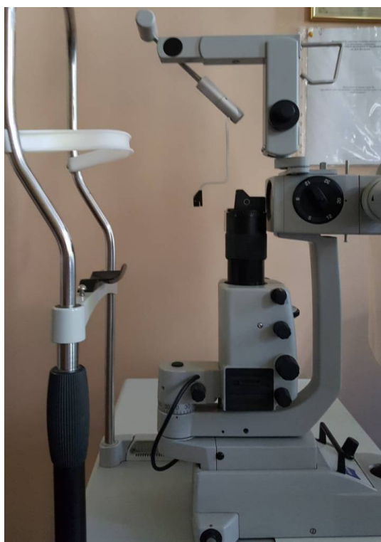
Рис. 5. Штатив тонометра Гольдмана, закрепленный на биомикроскопе.
