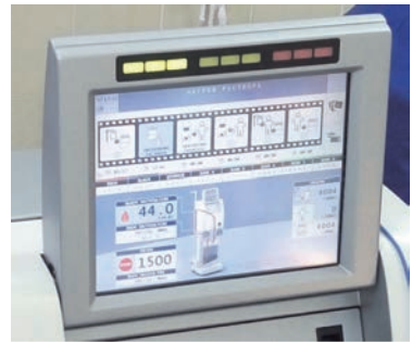
Рис. 2. Показатели работы системы: целевая температура – 44 °С, объём – 1500 мл, II фаза работы (из 6 – см. линейку в верхней части монитора) – нагрев раствора
