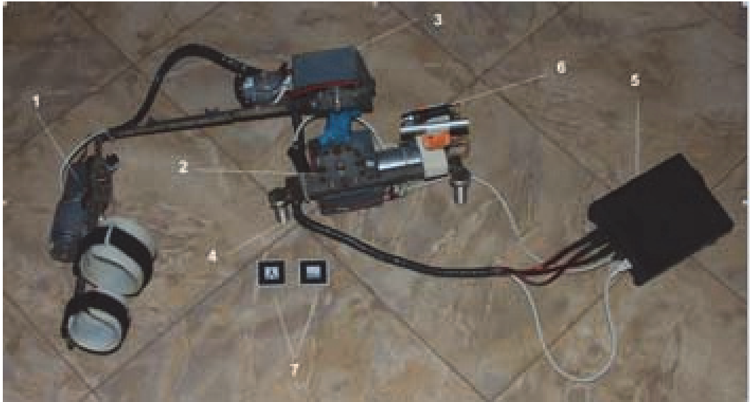
Рис.1. Компьютерно-аппаратный комплекс. 1 – мотор оси ротации; 2 – мотор оси отведения; 3 – мотор оси сгибания; 4 – крепление к операционному столу; 5 – управляющий блок; 6 – лазерный моторизированный направляющий; 7 – металлизированные маркеры
