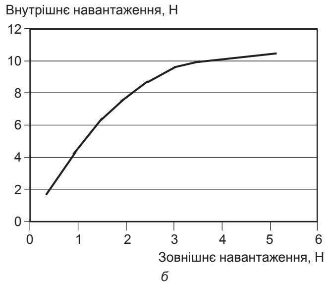
Рис. 5. Залежність внутрішнього зусилля від зовнішнього навантаження за фізичним експериментом (а) та математичною моделлю (б)
