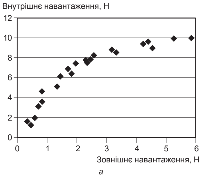
Рис. 5. Залежність внутрішнього зусилля від зовнішнього навантаження за фізичним експериментом (а) та математичною моделлю (б)
