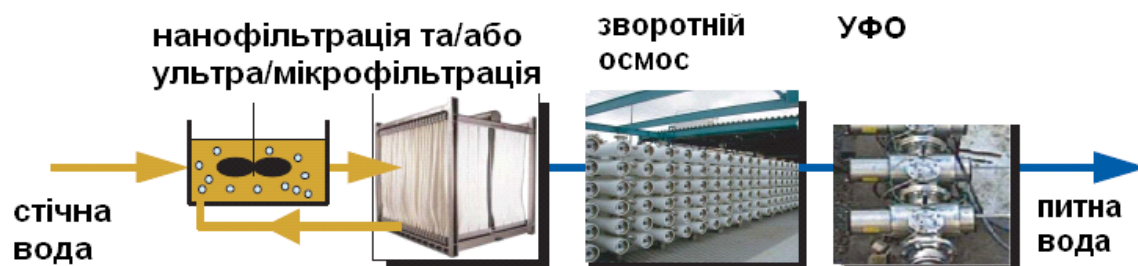
Рис. 1 Схема очистки стічних вод із застосуванням нанofільтрів
