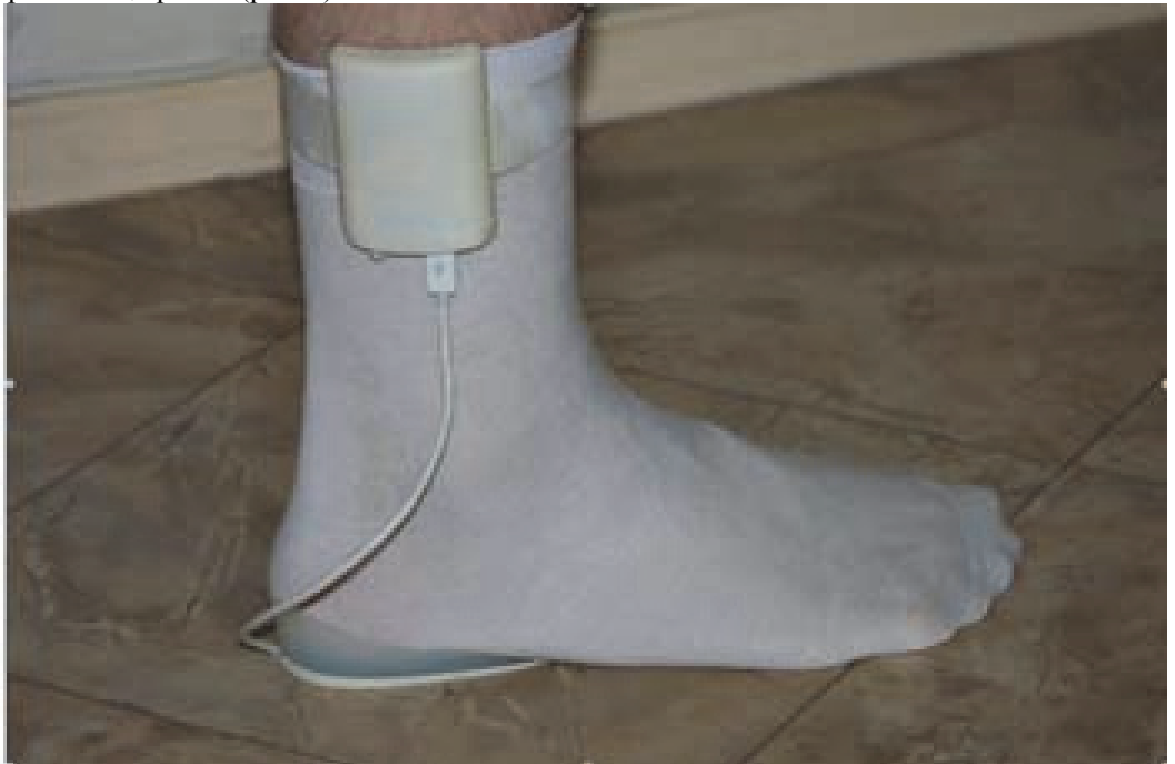
Рис.2. Расположение датчика веса и крепление основного блока.
