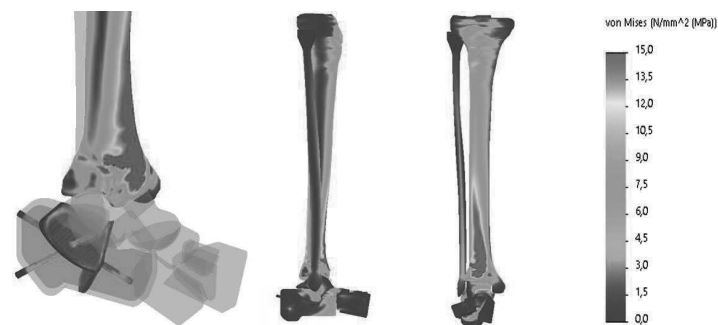
Рис. 4.34 Розподіл напружень на фіксуючих елементах моделі імпресійного перелому п'яtkової кістки, фіксованої гвинтами
