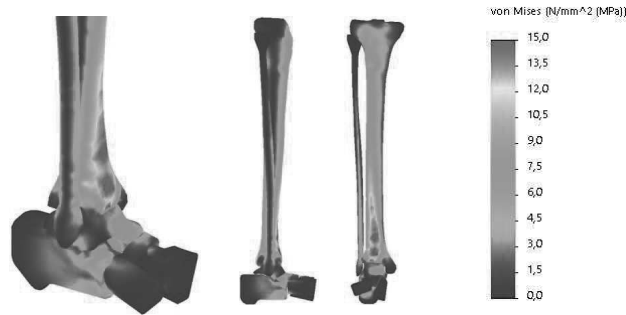
Рис. 4.24 Розподіл напружень на моделі ЗВС в нормі
