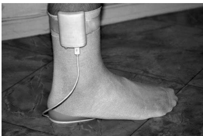
Рис. 7.2 Зовнішній вигляд пристрою для визначення навантаження на стопу
