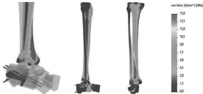
Рис. 4.31 Розподіл напружень на фіксуючих елементах моделі язикоподібного перелому п'яткової кістки, фіксованої спицями
