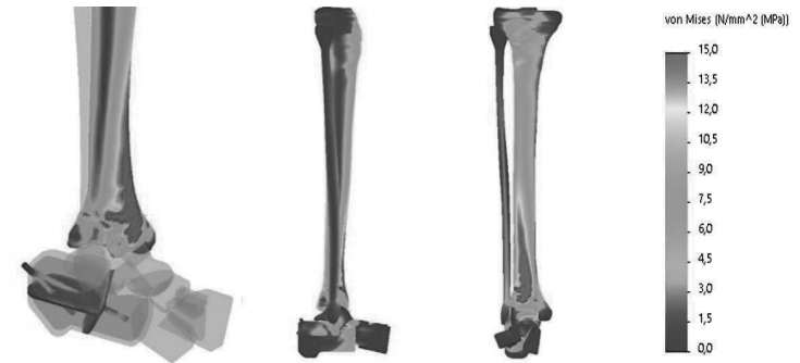
Рис. 4.32 Розподіл напружень на фіксуючих елементах моделі язикоподібного перелому п'яткової кістки, фіксованої гвинтами
