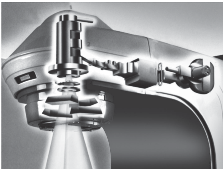
Рис. 13.1. Прискорювач на 4–6 МеВ
