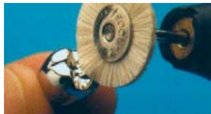
Рис. 6.13. Полировка металла волосяной щеткой
