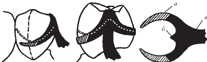
Рис. 5.6. Составные части опорно-удерживающего кламмера. Их расположение на зубе
