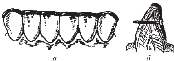
Рис. 7.6. Шина Треумана: а — вид спереди; б — в сагиттальном разрезе
