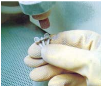
Рис. 6.8. Обработка металлических конструкций в пескоструйном аппарате
