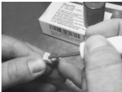
Рис. 4.1. Нанесення компенсаційного покриття
