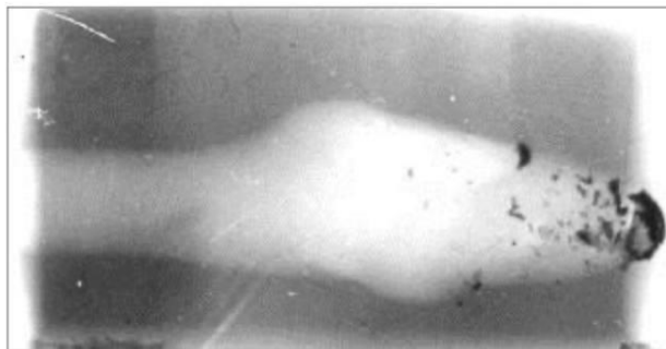
Рис. 3. Момент фрагментації раничого снаряду за даними імпульсної рентгенографії.
