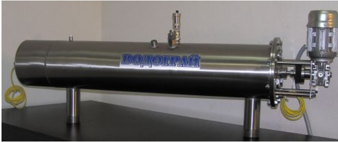
Рис. 2.2. Установка для УФ-обеззараживания
